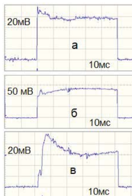
Рис. Осциллограммы при значении тока накачки 2,6 А для: а – лазерного диода 808 нм; б – первой гармоники; в – второй гармоники. Указана цена делений на экране осциллографа
